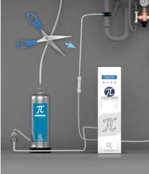
Bitte durchtrennen Sie die Abwasserleitung (DRAIN) nach dem bereits eingebauten Rückschlagventil 1.
