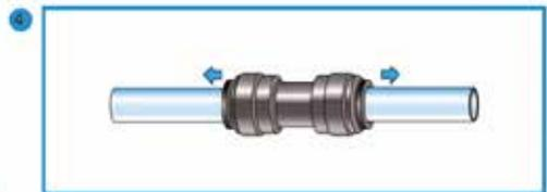
Überprüfen Sie, ob das Rohr sicher eingesteckt ist. Dies ist durch Gegenziehen leicht möglich.
